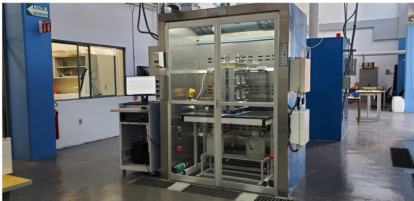
Figura 2. Prototipo de batería de flujo basada en materiales orgánicos Redox, desarrollada en el INEEL. Incluye stack, tanques de almacenamiento de electrolitos, bombas de recirculación, sensores de temperatura, flujo y estado de carga; así como sistema de control y adquisición de datos.
