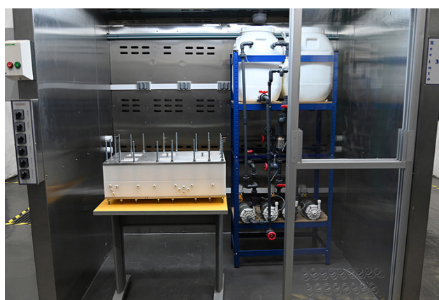
Figura 1. Prototipo de batería de flujo basada en electrodiálisis desarrollada en el INEEL.
