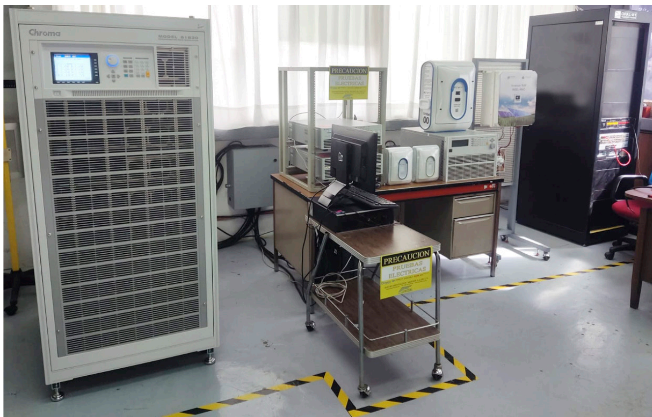
Figura 2. Plataforma de simulación avanzada del INEEL para prueba de inversores fotovoltaicos.
